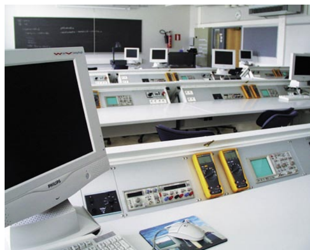
Laboratorioiden, tarkastamojen, sähkötyötilojen, fysiikan, elektroniikan ja sähkötekniikan opetusluokkien erilaiset sähkölähteet, testi- ja mittalaitteet koottuna yhteiseen työpöytään asennettavaan laitepaneeliin.
