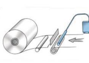
Kalvon kiinnittäminen hylsyyn rullan vaihdon yhteydessä.
