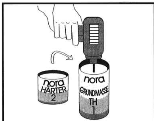
Perusmassa (1) sekoitetaan kovettajan (2) kanssa huolellisesti käyttäen apuna porakonetta ja saumamassan sekoitinta. (HUOM! massa on verrattain sitkeätä!)
